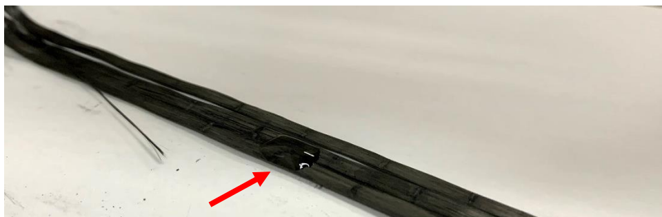
Figura 10: Teste de molhabilidade no tecido de carbono após tratamento com teflon e carbono descritos no item 2.1.3.
